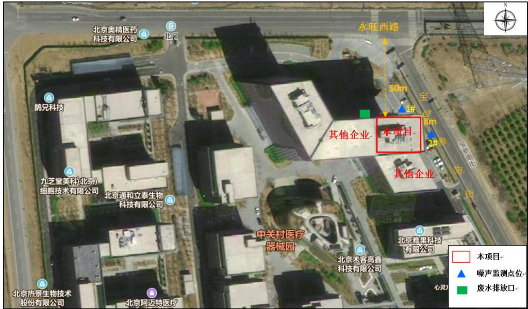
图 3-2 项目周边关系、噪声监测点位及排污口位置示意图
