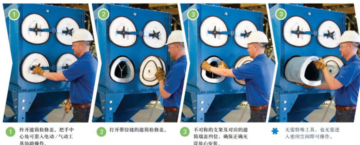
图9 唐纳森除尘器滤芯更换流程图
