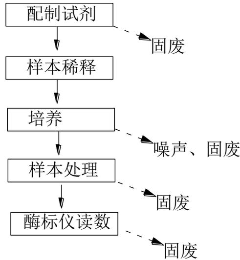
图4 项目工艺流程及产污节点图
