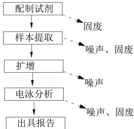
图3 项目工艺流程及产污节点图
