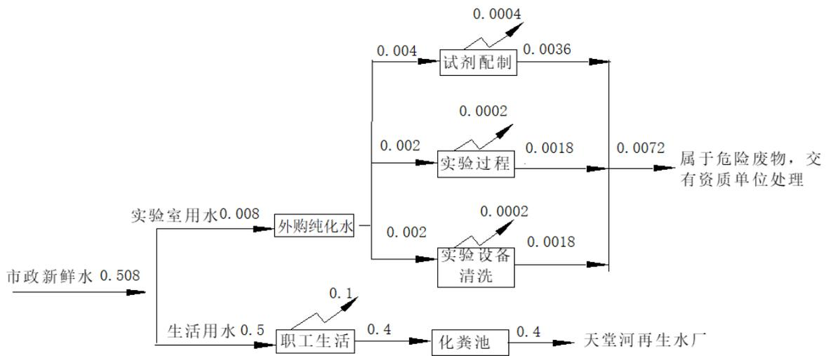
图1 建设项目水平衡图 单位：m<sup>3</sup>/d “ ”消耗量
