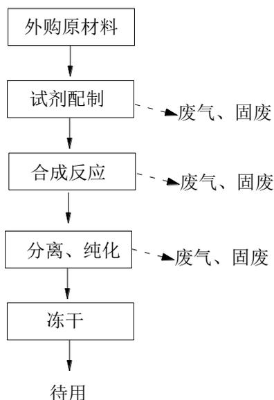
图 2 合成工艺流程及产污节点图
