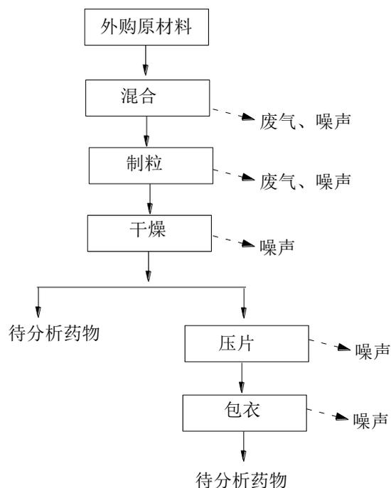
图 4 颗粒剂、片剂工艺流程及产污节点图
