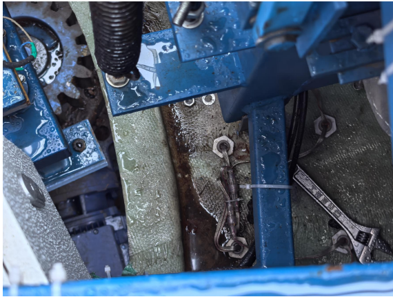
图 5 座舱内的扳手及零件情况
