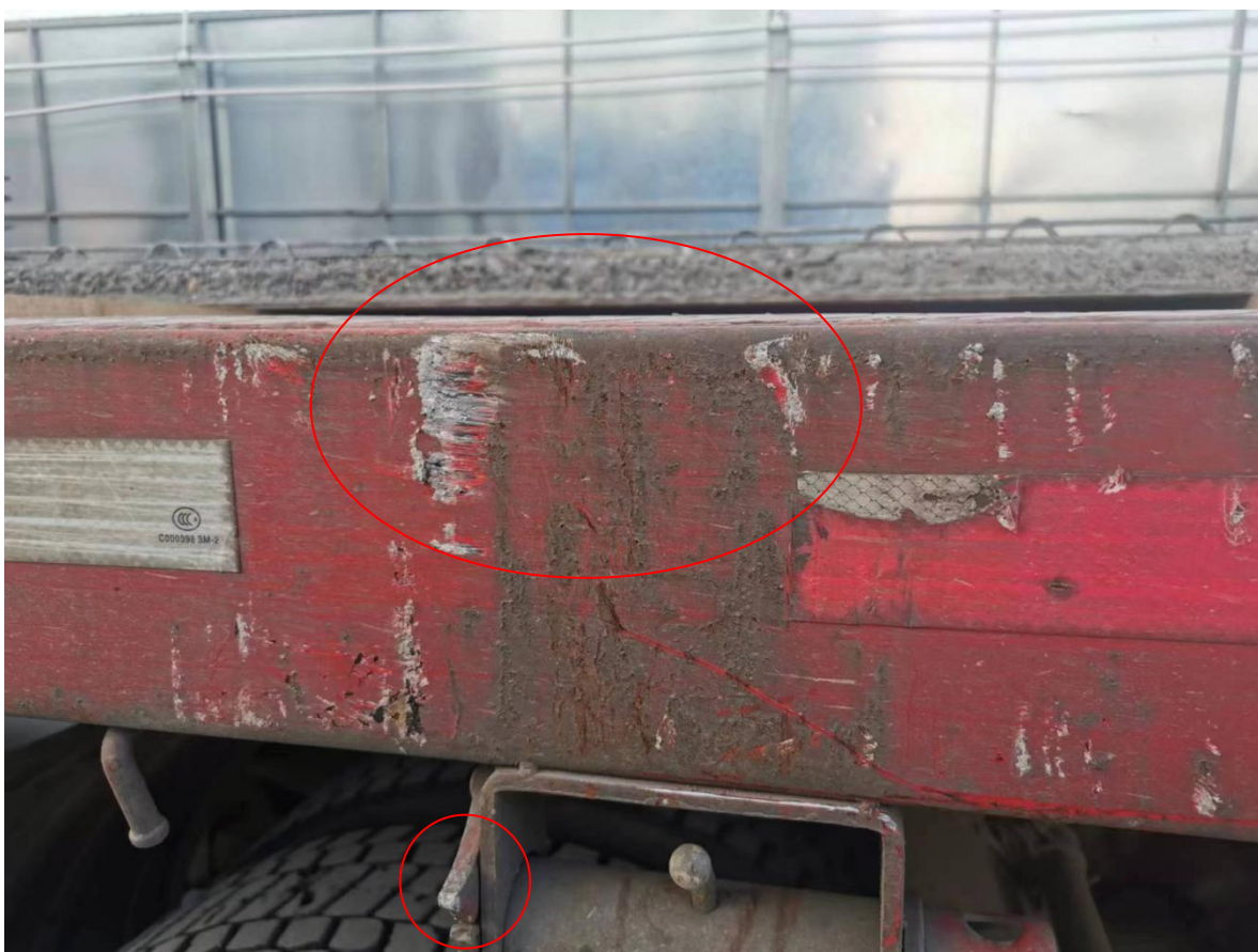
(图 6) 货车磕碰痕迹局部图示
