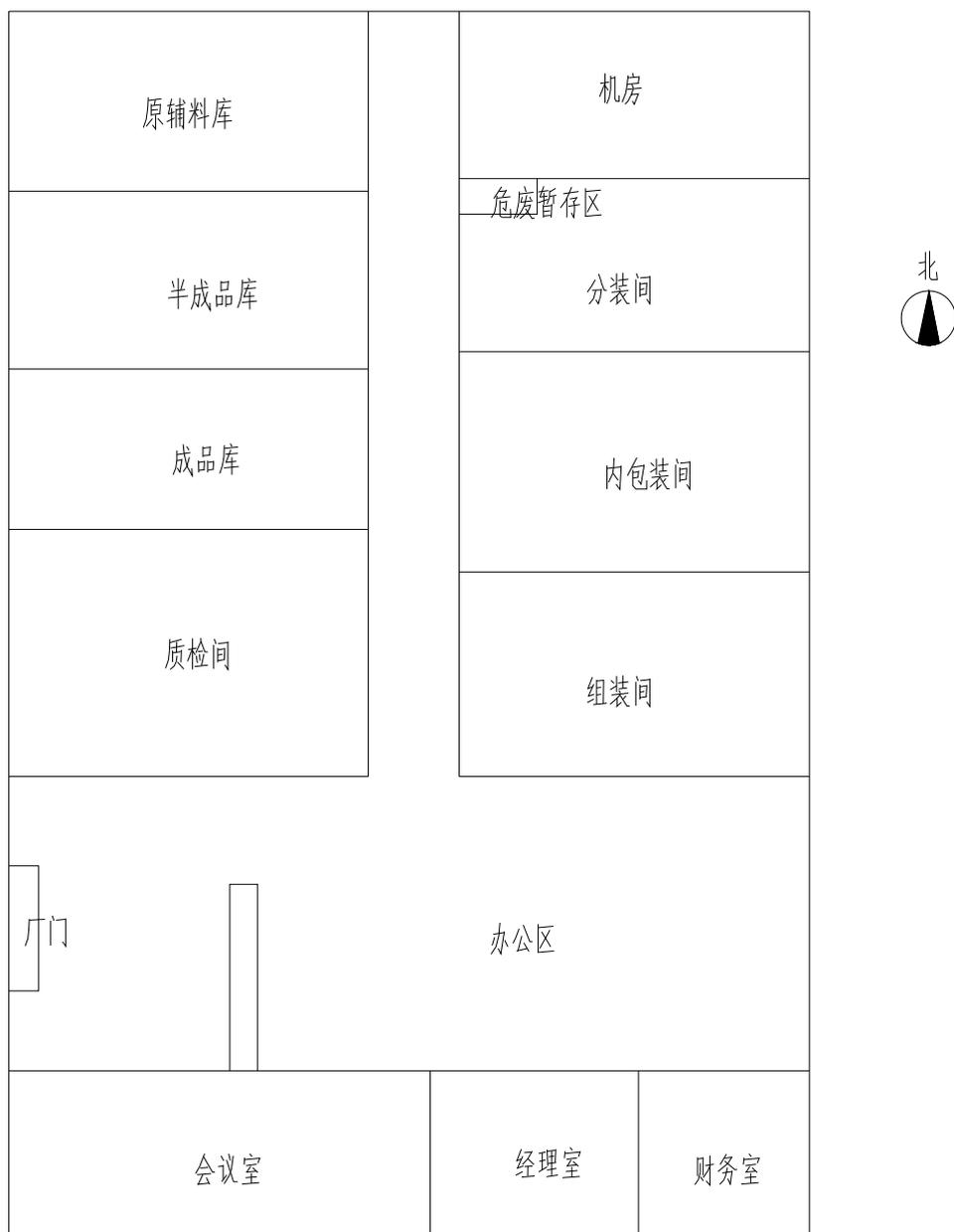
图3 建设项目平面布置图
