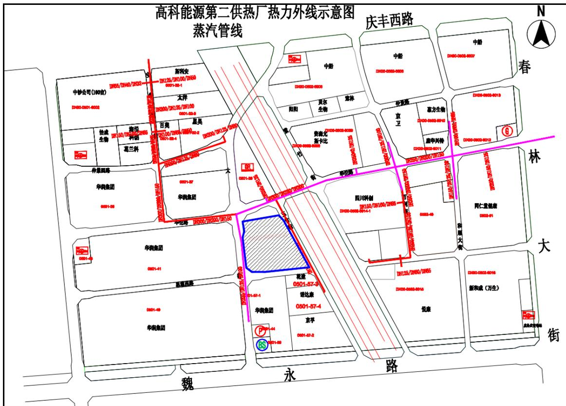
图 2 建设项目厂区外蒸汽管线布设示意图
