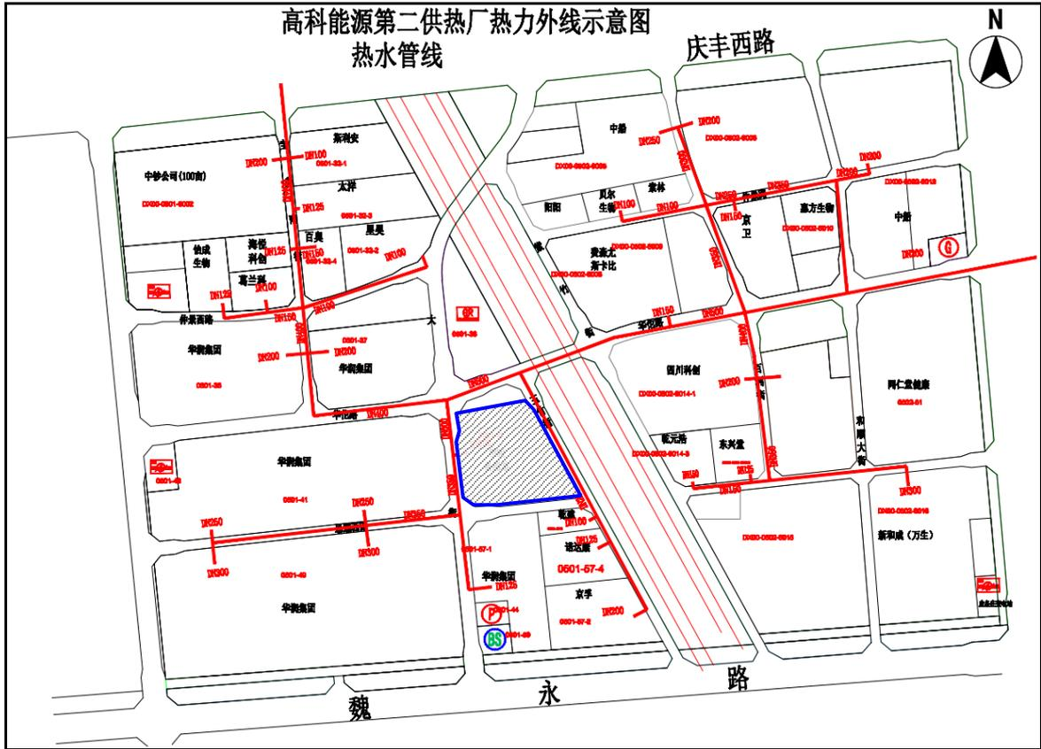
图 1 建设项目厂区外热水管线布设示意图
