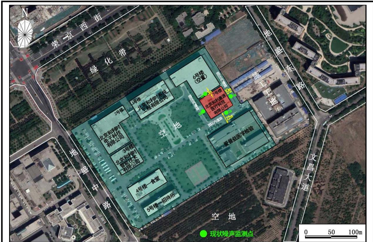
图3 现状噪声监测布点示意图
